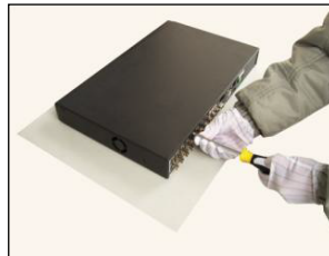
⑧ Die Schrauben wieder zuschrauben
