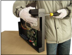
③ Za pomocą śrub zamocuj dysk twardy
