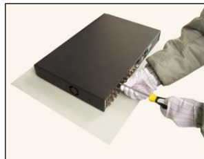
⑧ Rögzítse a burkolatot a csavarokkal
