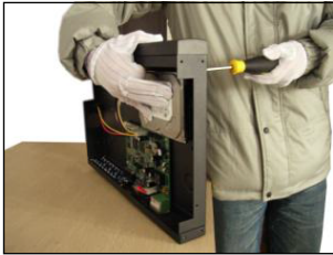
③ Die Festplatte mithilfe der Schrauben befestigen
