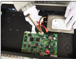
⑤ Podłącz kabel do transmisji danych
